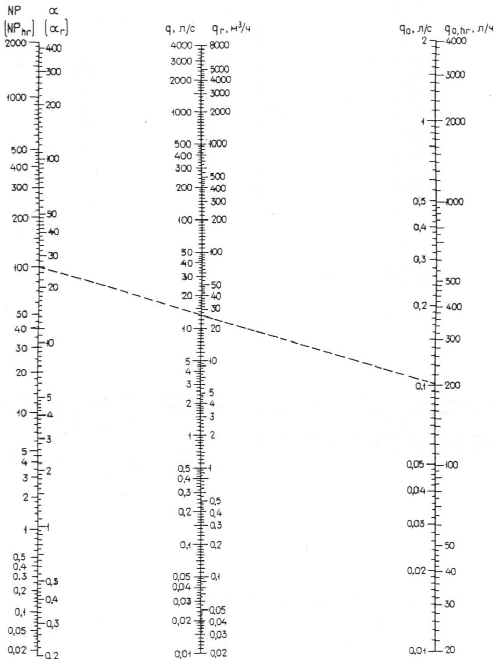
**Черт. 4. Номограмма для определения секундных и часовых расходов воды в зависимости от  $NP$  ( $NP_{hr}$ ) при различных значениях  $q_0$ ,  $l/c$ , и  $q_{0,hr}$ ,  $l/h$**
