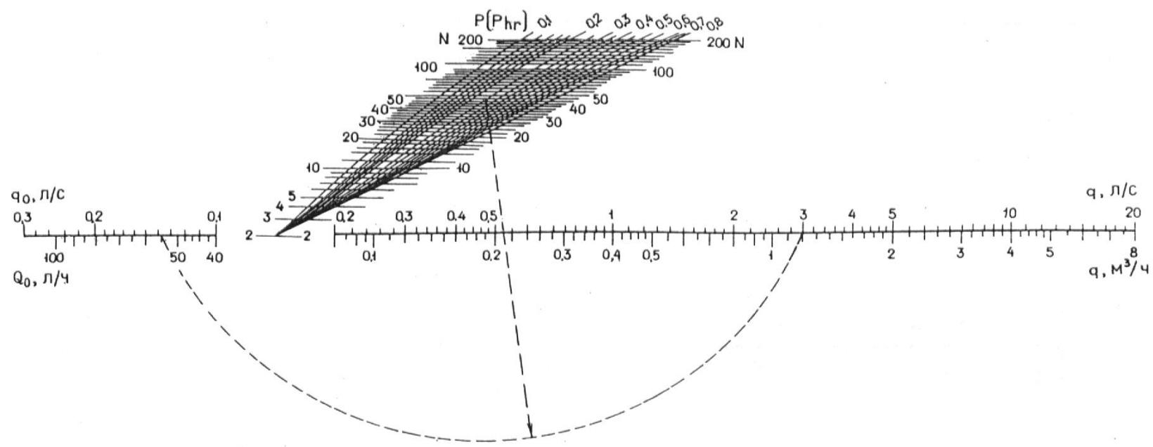
Черт. 3. Номограмма для определения секундных и часовых расходов воды  $q$  при  $q_0 \leq 0,3 \text{ л}/\text{с}$ ,  $N \leq 200$  и  $P > 0,1$
